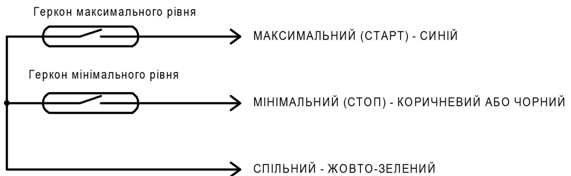
Рисунок 3 - Схема електрична принципова сенсора рівня молока
