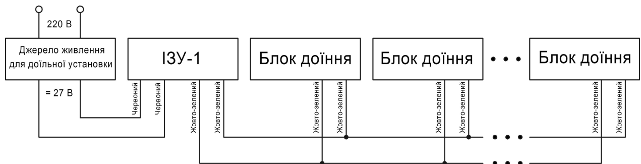
Рисунок 2 - Схема під'єднання ІЗУ-1 до джерела живлення доїльної установки та блоків доїння.
